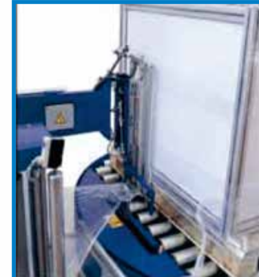
Option 1: Folienklemm-Schneideinheit (Nach Beenden der Wicklung wird die Folie mit der Schneideinheit geschnitten)
